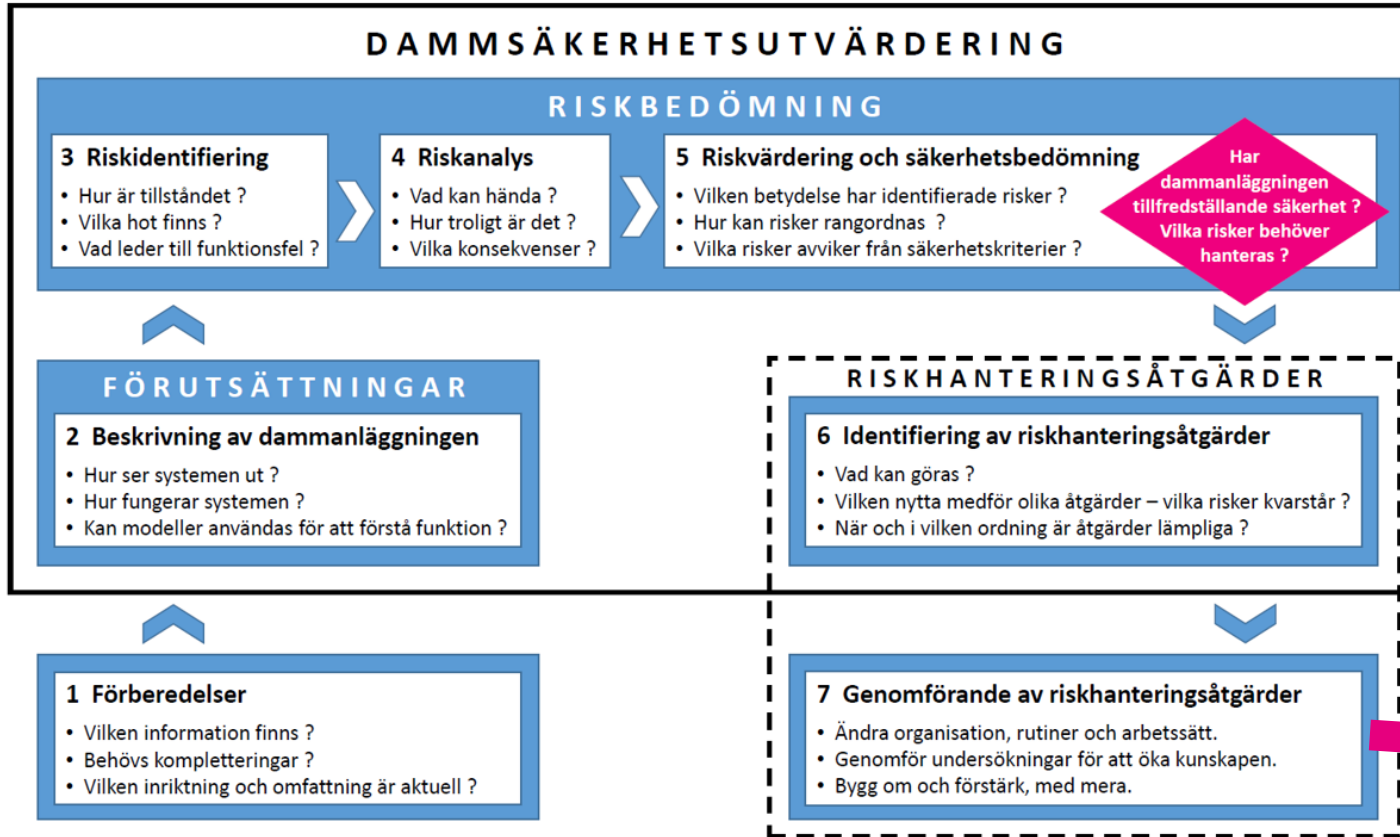
Figur 4. Dammsäkerhetsutvärdering (DSU) – steg och frågeställningar
