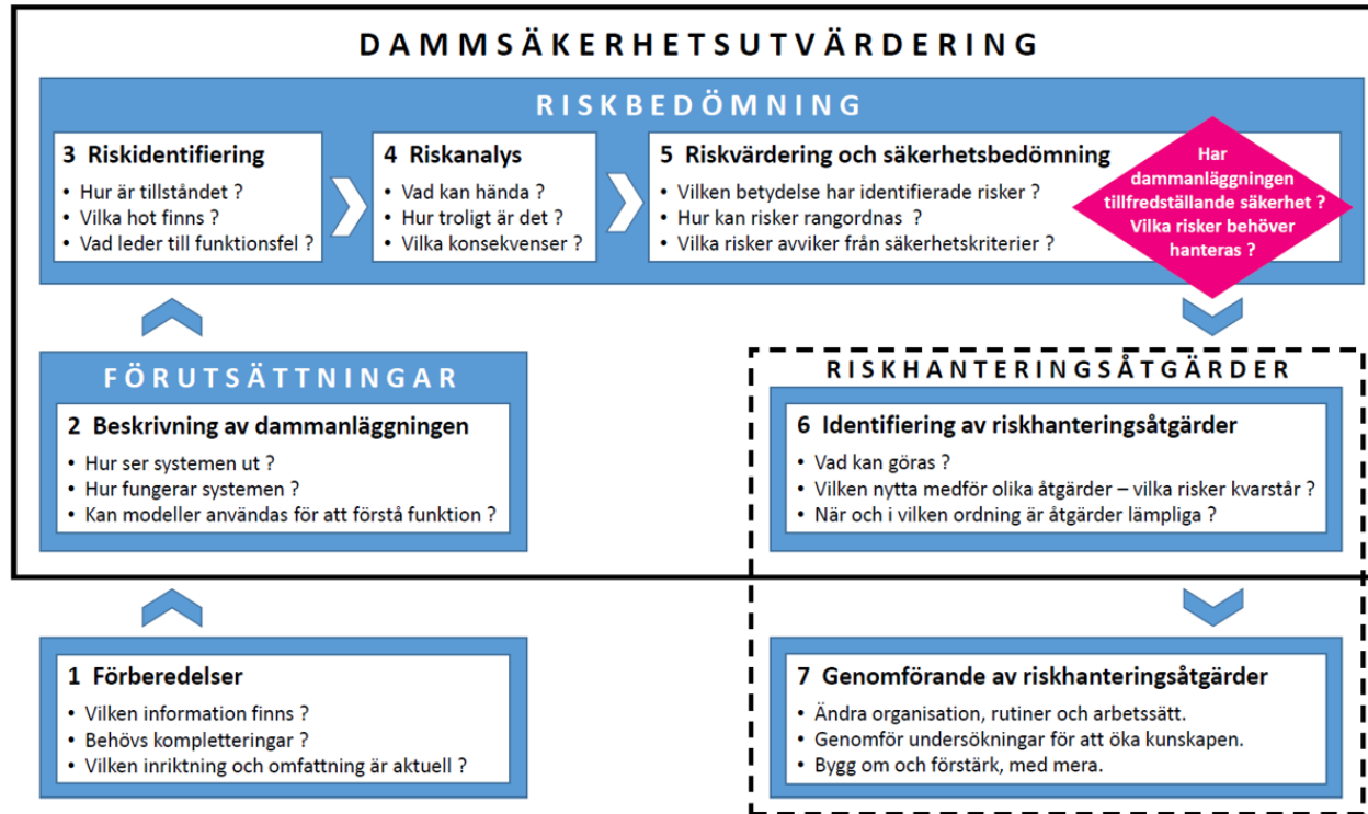
Figur 4. Dammsäkerhetsutvärdering (DSU) – steg och frågeställningar
