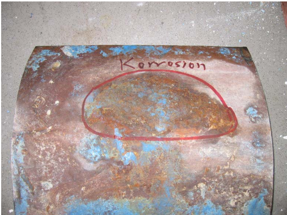
Bild 20 Större korrosionsskada vid -6,5 m på returledning i riktning bakåt, nedåt backe.
