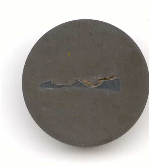
Bild 28 Botten på frätgrop som har tillväxt från utsidan. Kvarstående godstjocklek är som lägst ca 0,12 mm. Rörets insida är beläget överst i bilden. Röret har även angripits av invändig korrosion, se pil.
