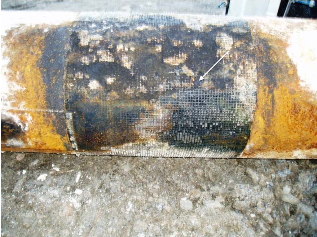
Bild 20 Större korrosionsskada vid -6,5 m på returledning i riktning bakåt, nedåt backe.
